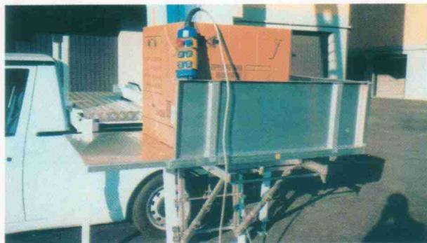
Los paneles laterales de la plataforma de carga se posicionan de diversas maneras. También se pueden quitar, permitiendo la elevación de cargas de las más variadas formas. La plataforma de carga puede ser girada y entrar en la ventana o balcón, facilitando las operaciones de carga y descarga.
